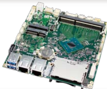
Intel Model: VX-6020 ◇ 125 × 140mm ◇ DDR3 SO-DIMM memory ◇ ECC ◇ 単一電源動作(ワイドレンジ12V) E3800ファミリー搭載 組込み向けCPUボード
