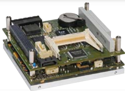
Intel Model: MIP11 ◇ Intel ◇ ~ 1.8GHz ◇ Pentium M, Celeron ◇ ~ 1.25GB 低消費電力Pentium M, Celeron搭載ファンレスCPUカード
