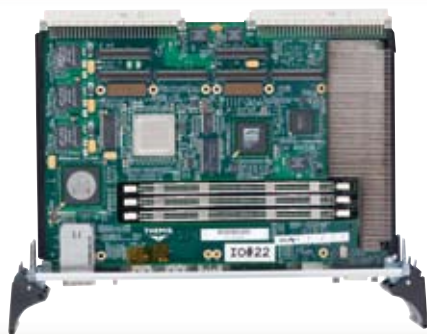
Intel Model: XV2 ◇ Intel ◇ 2.13GHz ◇ Quad Core Xeon ◇ ~24GB DDR2 Quad Core Xeon搭載 VMEボード
