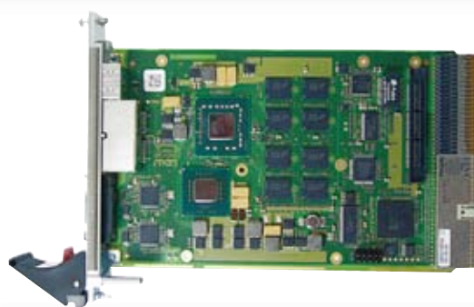
Intel Model: F18 ◇Intel ◇2.2GHz ◇Core 2 Duo T7500 ◇~4GB DDR2 Core 2 Duo搭載CompactPCIボード
