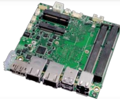
Intel Model: IX-5050 ◇ 100 × 100mm ◇ Dual DDR3 SO-DIMM memory ◇ ECC ◇ 単一電源動作(ワイドレンジ12V) 3rd Generation Intel Core i7/i5/i3/Celeron 搭載CPUボード
